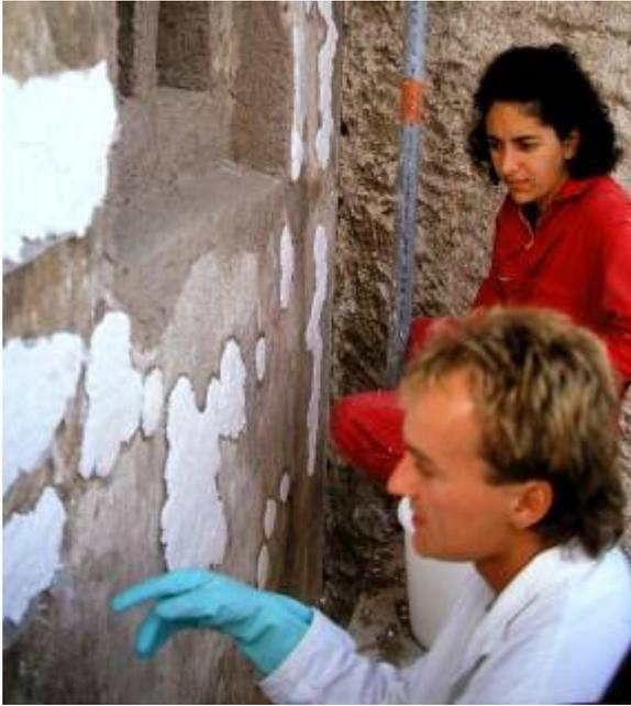
Abb. 22: Weissenkirchen / Niederösterreich, Pfarrkirche, Turm 14. Jh., Fassade mit Krusten durch Vergipsung: Ammoniumcarbonat-Kompressen. Foto Hammer 1989
