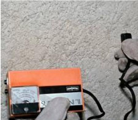
Abb. 14: Messung der elektrischen Leitfähigkeit der Oberfläche
